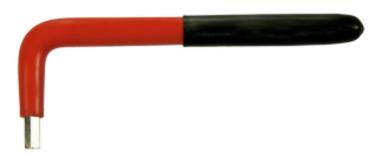
1000V ISOLERT UNBRACO. I.h.h.t. IEC 60900 Isolert verktøy med tofarget og dobbeltisolert håndtak for arbeid på spenning inntil 1000 V (AC). Synlig isolasjon er rød PVC i en anti-skliutførelse som gir et godt og sikkert arbeidsgrep. Når isolasjonen er skadet kommer lag 2 til syne (gul farge) verktøyet er da ikke godkjent som AUS-verktøy lenger. Alle verktøy er individuelt testet og merket deretter. Utførelse i kromvanadium stål.
